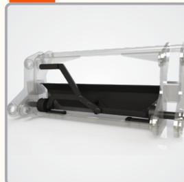
Possibilita o engate e o desengate dos opcionais com agilidade, por meio da articulação de uma alavanca acionada manualmente que realiza uma dupla ação nos pinos-trava.
