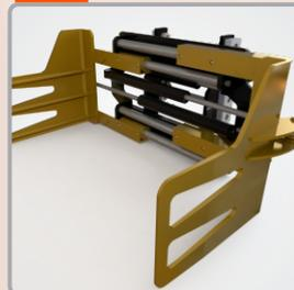
Permite o transporte e o empilhamento de fardos de algodão pelo sistema de prensagem. A articulação dos cilindros, por meio de guias, permite aos braços pressionadores o deslocamento simétrico.
