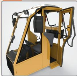
Além da cabine fechada, inclui limpador de para-brisa, aberturas em vidro, saída de emergência e climatizador ou ar condicionado. Possibilita maior conforto e segurança nas operações.
