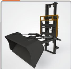
Permite o transporte e elevação de materiais granulados. O conjunto é fixado nos garfos e articulado por meio de 2 cilindros alimentados pelas mangueiras do cilindro de deslocamento dos garfos.
