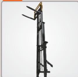
Possui 3 estágios de elevação, com altura máxima de 5,25 m. Até certa altura, os garfos sobem sem que o 2º e o 3º estágios subam, tornando-a propícia para trabalhar em alturas limitadas. A capacidade de carga varia dependendo da altura.
