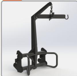
Usado para o transporte e elevação de big-bag até 1000 kg, garante maior segurança e confiabilidade nas operações. O travessão que sustenta o big-bag é apoiado por manilha e gancho giratório, permitindo versatilidade no manuseio durante a operação. Possui sistema de engate rápido para facilitar a troca do equipamento.
